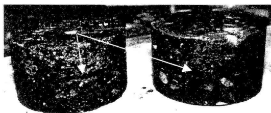
図-9 凝灰岩に生じた亀裂 (左:層雲峡溶結凝灰岩,右:支笏溶結凝灰岩)
