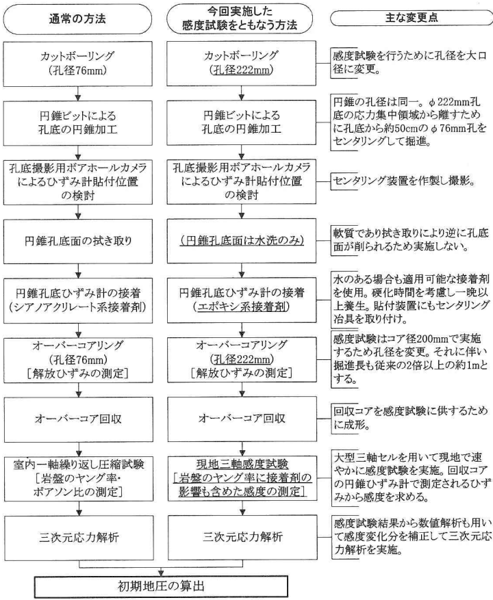
図2 円錐孔底ひずみ法の測定の流れ
