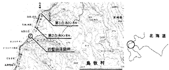
図－1 第2白糸トンネル岩盤崩落の位置 4)
