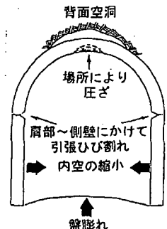
図4 六十里越トンネルの主な変状状況
