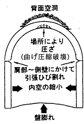
図-2 代表的な変状状況の模式図 1), 2)
