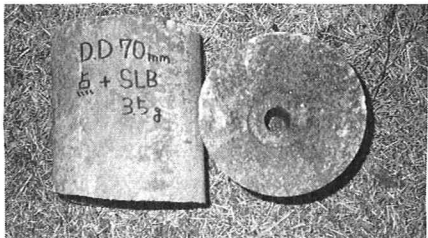
写真-4 コンクリート破砕器による破碎 (点+CB3.5g)
