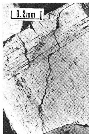
写真-4 斜長石粒内を伝播するクラック（3点曲げ試験）
