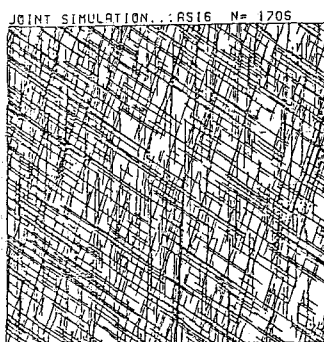
図-1 電気模型で用いた割れ目モデル (GrG)
