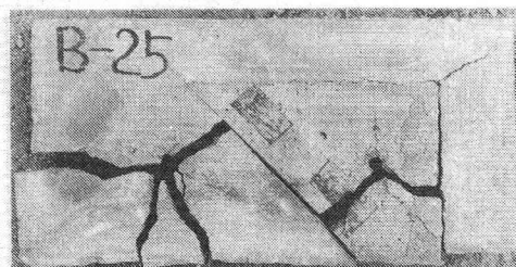
写真-2 不連続面のある場合 左: S=15\text{cm} 右: S=25\text{cm}
