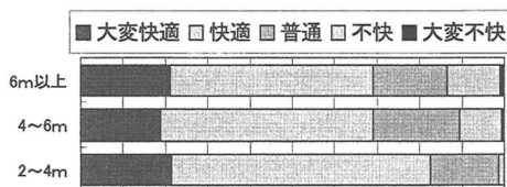
図-20 駐車・路上占有物による走行妨害度と幅員
