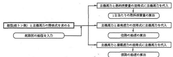
図3 燃料消費量、及び船速の算出方法
