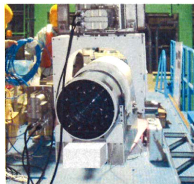
写真-1 4-DWISSの水中部（水中音響カメラ）
