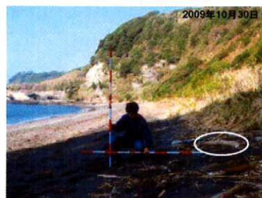
図-13 海浜aの測線①付近での砂の堆積 (2009年10月30日)
