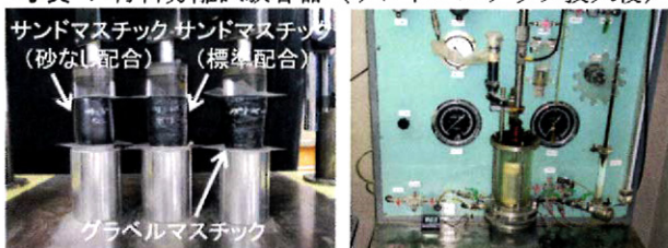
写真-2 圧縮試験 (左: 一軸圧縮試験, 右: 三軸圧縮試験)
