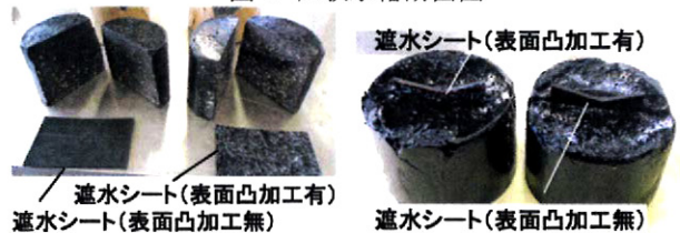
写真-6 透水試験（左：供試体切断と遮水シート、右：透水試験に用いた供試体、下：試験状況）
