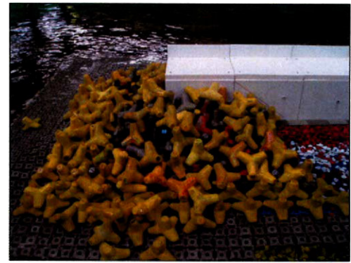
写真-1 堤頭部側面・背面の消波ブロック被害状況
