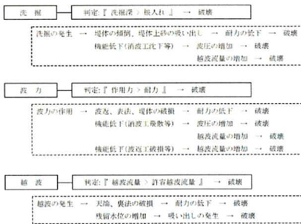
図-4 破壊過程の分類
