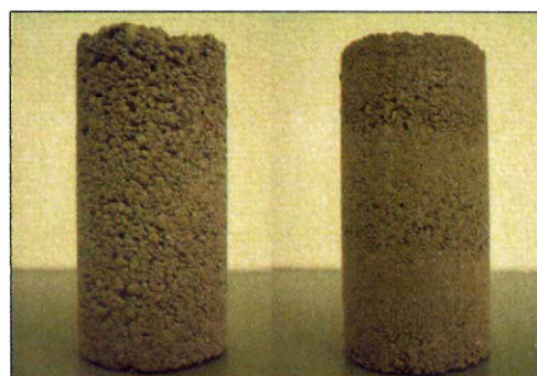
写真-2 脱枠直後の供試体の外観
