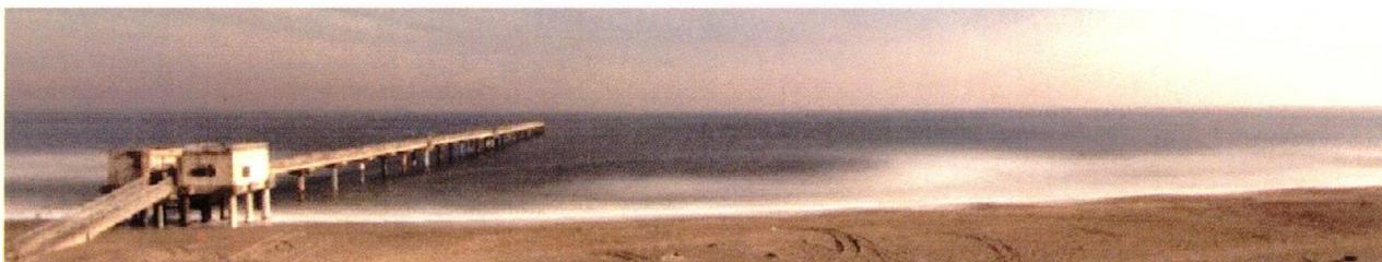
図-10 ネットワークカメラの画像を平均化した平均画像。平均化時間：300 秒
