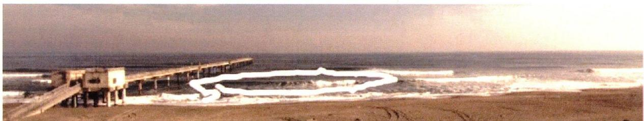
図-9 ネットワークカメラの画像とフロート軌跡。画像は広角レンズの使用による歪を補正し、上下をトリミングして表示。栈橋の全長：400 m。軌跡のサイズ：岸沖方向約 150 m、沿岸方向 100 m。
