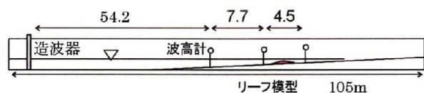
図-3 実験水路と模型設置位置
