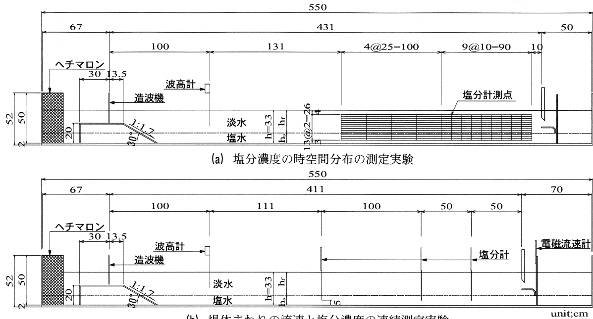
図-1 実験水槽の概要と計測器配置図
