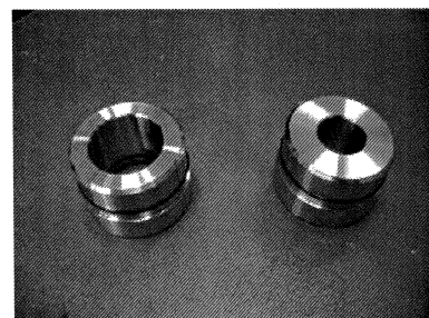
図-5 パイプのエンドキャップ (左: 内管径 30mm, 右: 内管径 20mm)
