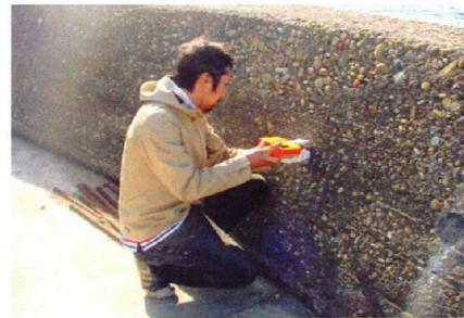
図-8 反発度法の実施状況
