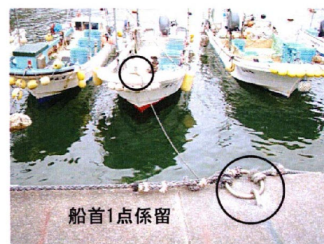
写真-1 現地における船首1点係留の例
