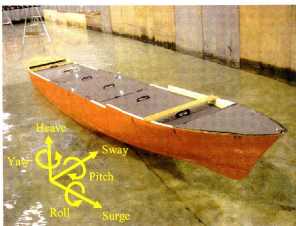
写真-1 船舶模型と動揺6成分の定義
