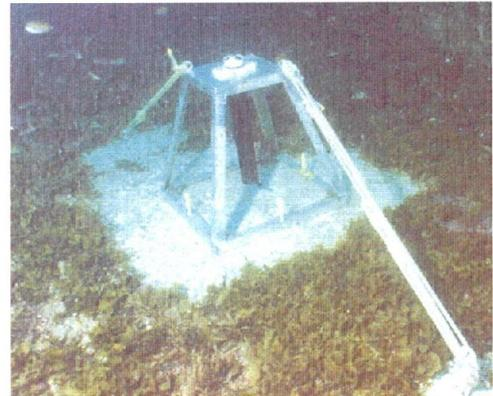
写真-1 超音波式多層流速計 (ADCP)
