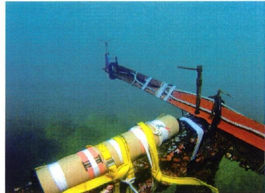
写真-2 超音波流速計設置状況
