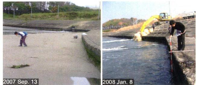
写真-2 台風9号来襲直後(9月13日)および4ヵ月後(1月8日)における放水口前面の堆砂状況。
