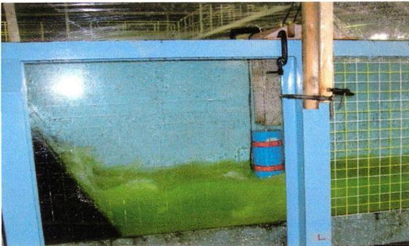
図-15 橋脚に作用する波の状況
