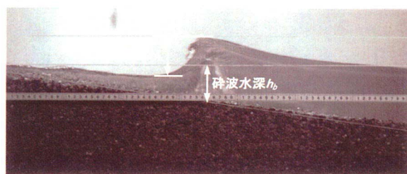
写真-1 砕波波高と砕波水深の定義
