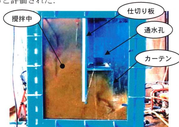
写真-8 濁り防止対策の検討実験状況
