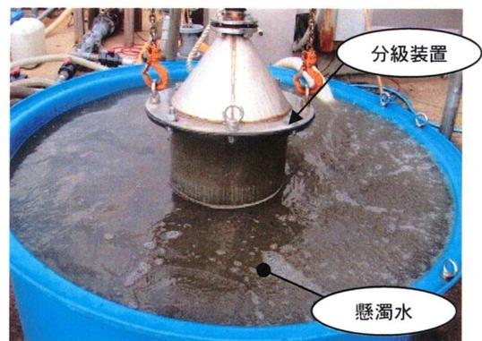
写真-5 分級性能確認実験状況
