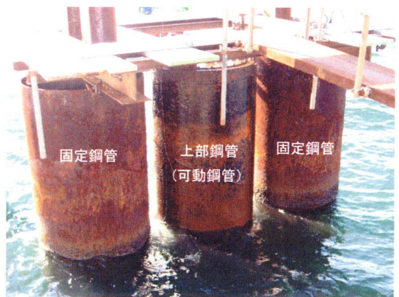
写真-1 実証試験施設(可動鋼管及び固定鋼管)
