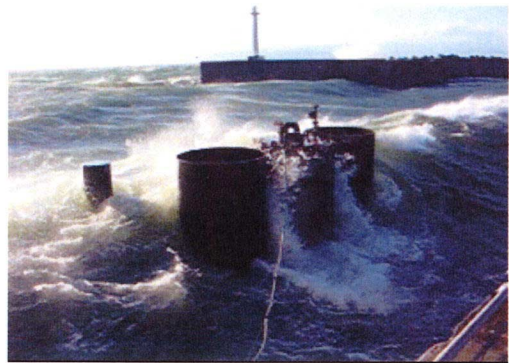
写真-7 加速度の計測状況(11月7日 H_{1/3}=1.0\text{m} )
