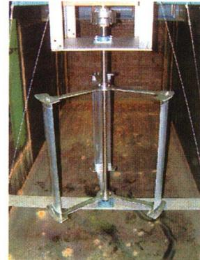
図-7 回流水槽中の実験模型
