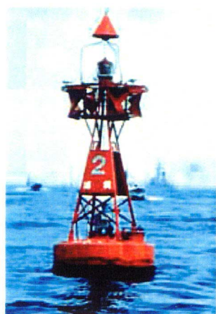
写真-1 波力発電による航路標識ブイ
