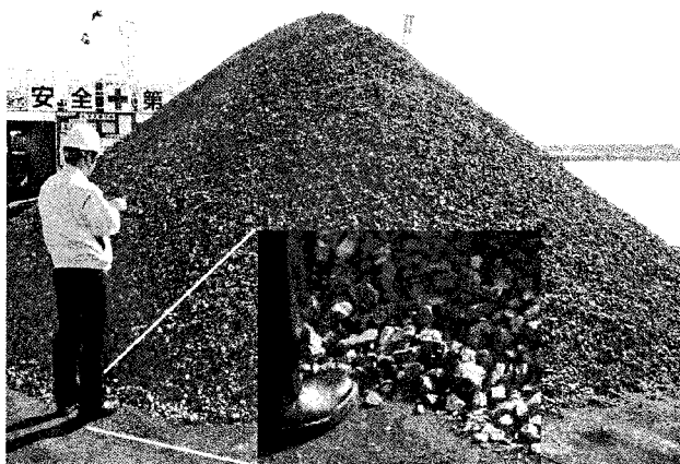
写真-1 投入前に船積みされた細粒碎石
