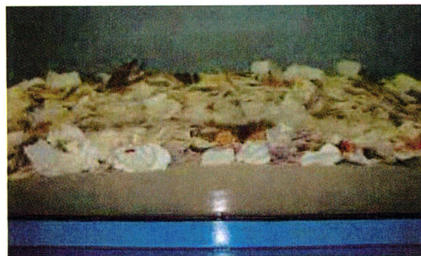
写真-3 貝殻片(11.2～22.4mm)の敷設状況
