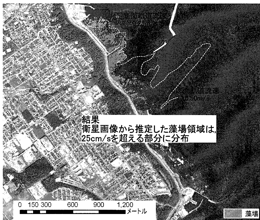
図-9 藻場の抽出結果と底面軌道流速
