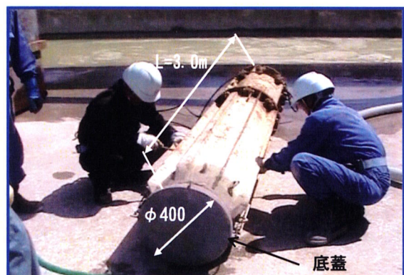
写真-5 現地試験装置（ケーシング）
