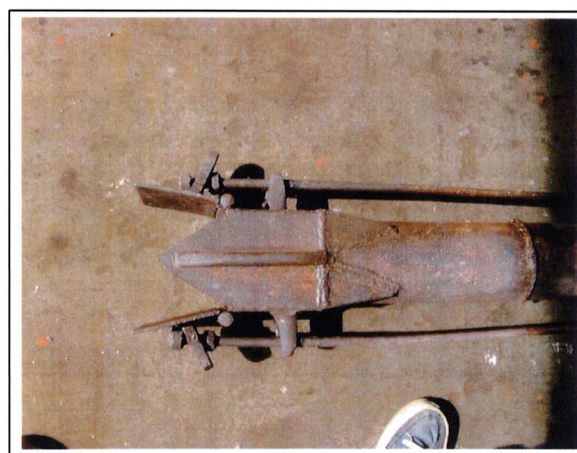
写真-2 油圧式自動開閉装置の詳細
