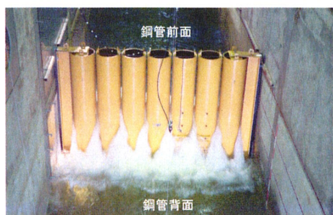
写真-2 鋼管背後から見た通過波の状況 (津波対象波)
