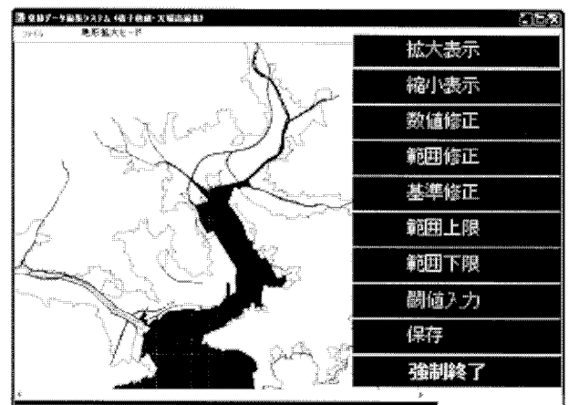
図-6 計算格子水深および構造物天端高の編集画面
