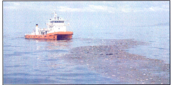
写真-1 浮遊ゴミの清掃船による回収状況
