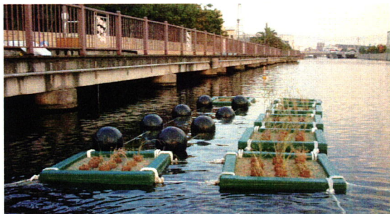
写真-4 浮体実験（直立護岸前面に浮体を浮かべて、そこにヨシ類やアマモを育生する実験）
