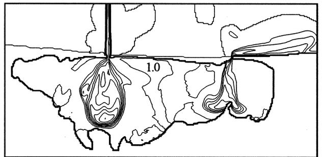
図-8 潮汐1周期後の拡散物質濃度分布\_流動制御無し
