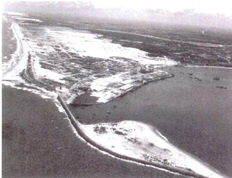
写真-4 港内堆砂状況 (防砂堤建設後)
