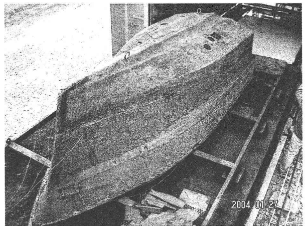
図-2 炭化時に自重で変形したFRP漁船 (FRP漁船5m級、船尾より見た状態)
