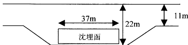
図-2 沈埋函沈設状況
