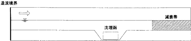
図-2 断面二次元水路概念図
