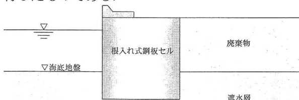
図-1 管理型廃棄物埋立護岸の概念図
