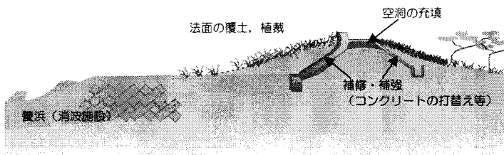
図-4 海岸堤防の覆土・緑化イメージ図
