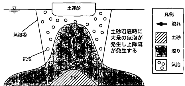
図-15 水面付近の濁りの発生メカニズム
