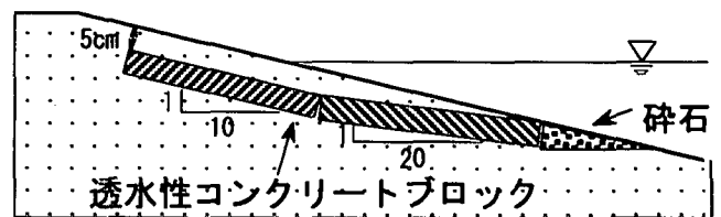
図-4 CASE2~CASE6の透水性ブロック設置断面図
