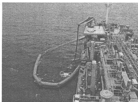
写真-3 投げ込み式油回収器
