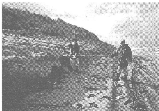
写真-5 浜崖形成の始点付近の状況。約0.7mの浜崖が形成され、下部にはノッチも見られる。
