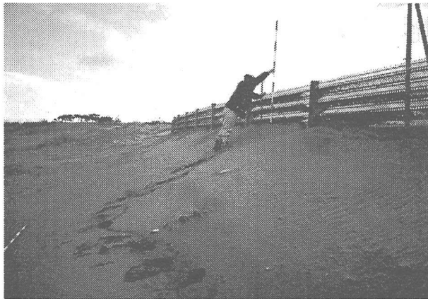
写真-14 写真-15に示した地点よりもさらに内陸側でのフェンスへの飛砂の堆積状況
